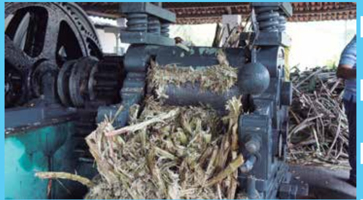
O processo de moagem da cana-de-açúcar é a primeira etapa
